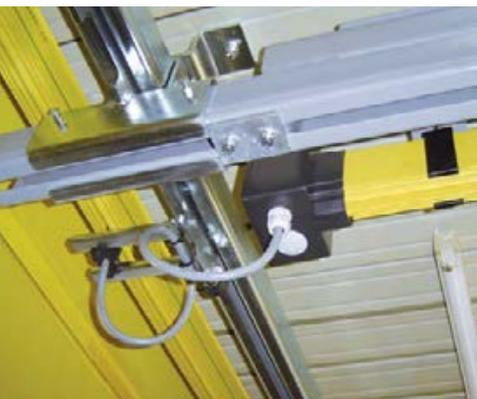
Kombinierte Zuverlässigkeit mit **Kastenschleifleitungen** an einem **Gerätekran**.
