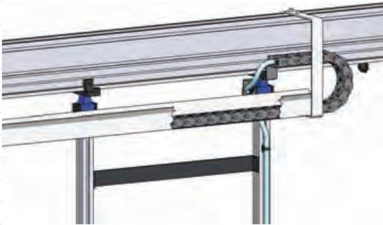
Ideale Lösung für die kontinuierliche Zuführung von Druckluft und Strom sowie die Verwendung von Datenleitungen, z.B. für die Erfassung der Daten von Schraubverbindungen.
